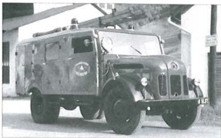
2. Auto Steyr 1500. Umgebautes Heeresfahrzeug auf ein Löschfahrzeug. 1962 gekauft von der FF Gresten, Aufbau in Eigenregie aus Ersatzteilen.
